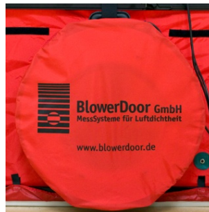
Fig. 6.39: Fan with fan cap
